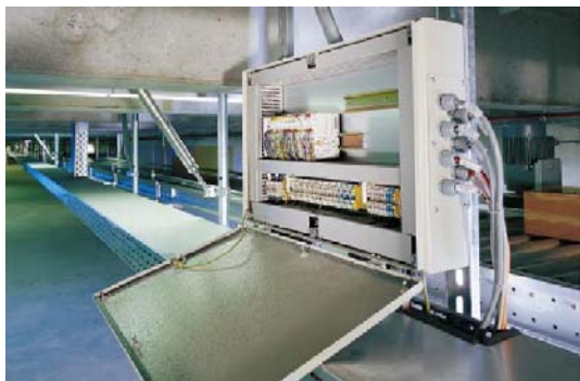
Идея распределенного автоматического управления становится особенно ценной, когда подразделения объекта размещены на большой территории
