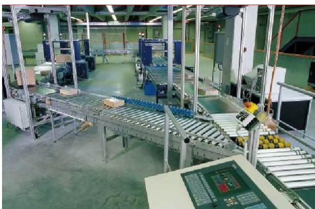
Товары, обработка которых завершена, поступают на выходной конвейер после «диалога» между управляющим и логистическим компьютерами
