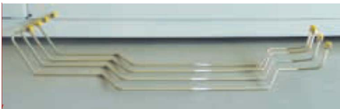
Трубы с соединительными элементами после гибки
